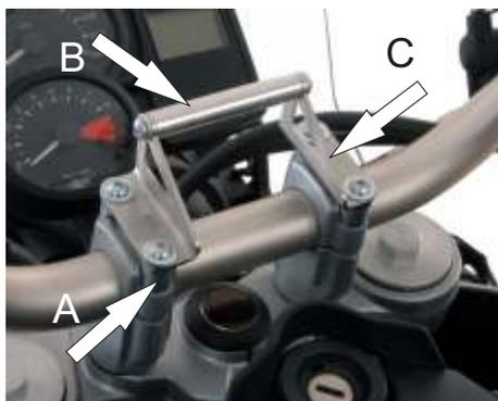
2.) Ersetzen Sie die vier inneren Schrauben der Lenkerklemmung (Bild 1) gegen die beiliegenden Schrauben mit Innengewinde (Bild 2/A). M5x10)
